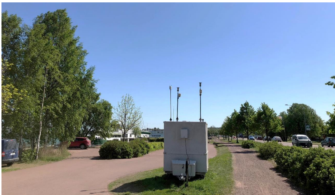
Figur 20. Mätstation för luftkvalitet i Mariehamn i maj 2018. Uteluften dras in i mätanordningar genom provtagningssonder på mätstationens tak. Bild: Mika Vestenius.
