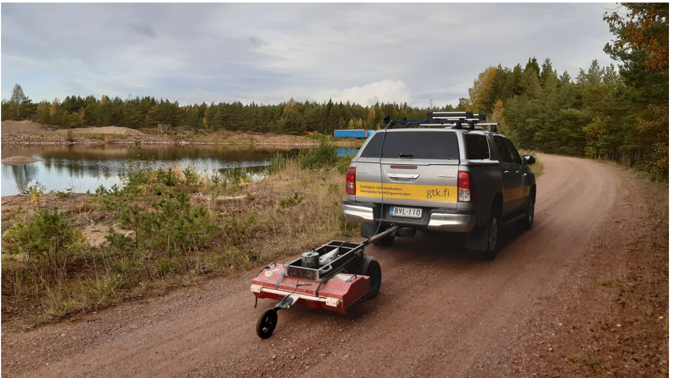
Fig. 9. Markradarmätning i Långmo grundvattenområde. Bild J. Ojalainen, GTK.
