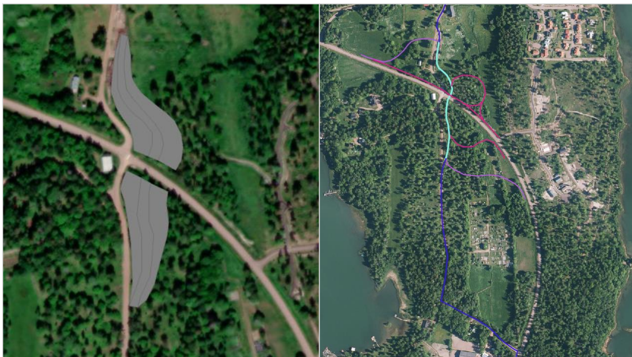
Figur 30 Schematisk skiss av en planskild passage för gående och cyklister vid Espholmsvägen. Till vänster: Utrymmesbehov för en lösning med 3 m bred gång- och cykelväg, 5 % längslutning på gång- och cykelvägen och slänter med lutning 1:4. Till höger: alternativa lösningar för att koppla samman passagen med föreslagna gång- och cykelväg.
