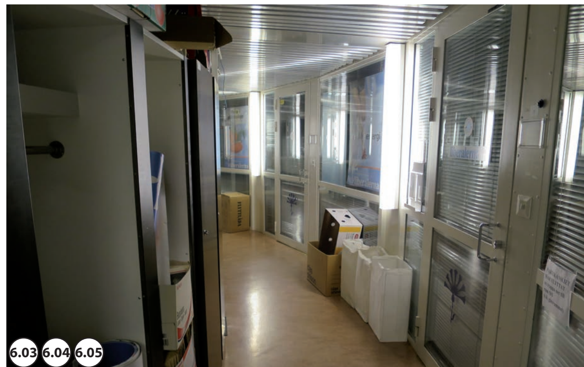
Breddmått 1380 mm. Belysningsarmaturer på vägg bländar och reflexer i blankt undertak. Fristående föremål i korridor.
